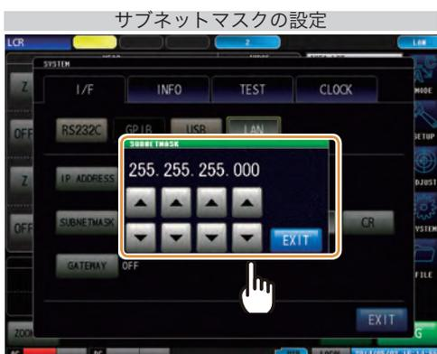
▲、▼ でサブネットマスクの設定をし、EXIT を押して、設定を確定する。
